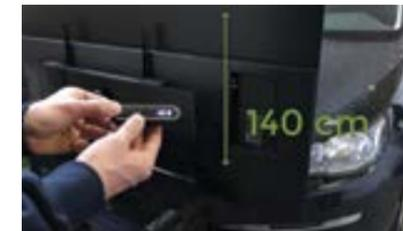
**6. DIE KALIBRIERUNG BEGINNT. DER MONITOR ZEIGT DIE KALIBRIERUNGS-TAFEL AN UND PASST DIESE, JE NACH POSITION DES FAHRZEUGS, FÜR DIE GENAUE WARTUNG AN.**
