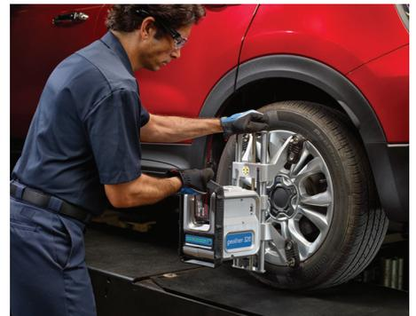
Einfach zu montierende PODs mit kabelloser Verbindung sowie rascher und einfacher Aufbewahrung nach dem Messvorgang.
