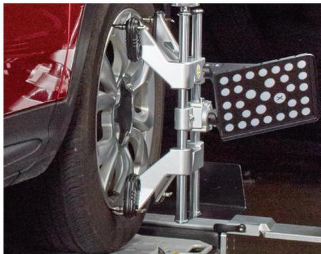
AC700-Radklammern aus Aluminiumguss, geeignet für Felgen von 11" bis 22" – ohne Einschränkungen – und einem Gewicht von 4,9 bis 5,2 kg pro Radklammer.
